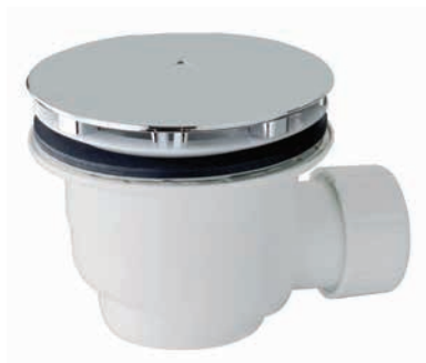
39lt/min Φ85xΦ40 3504 Vega σιφόνι ντουζιέρας με ύψος εντοιχισμού 8,5cm, οπή ντουζιέρας Φ63, έξοδος Φ40-1.1/2, κάλυμμα ABS
