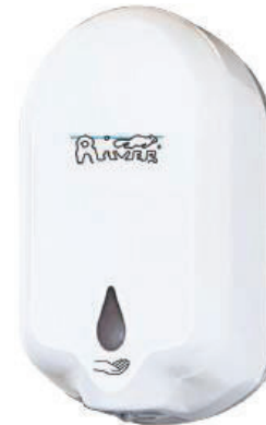
ABS Λευκό 17596 Ε610/2 Dispenser σαπουνιού ηλεκτρονικό, ενεργοποίηση με 4 αλκαλικές μπαταρίες 1,5V, για gel ή υγρό σαπούνι, χωρητικότητα 1,1lt, Υ.23,5xΠ.14xΒ.11cm
