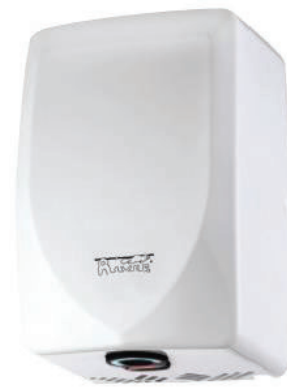
ABS Λευκό 17594 Ε612 Στεγνωτήρας χειρών ηλεκτρονικός, χρόνος λειτουργίας 10-12sec, 230V 50/60Hz 1000W, ταχύτητα αέρα 100MS, θερμοκρασία αέρα 40°C, Υ.25,6xΠ.17,4xΒ.10,2cm
