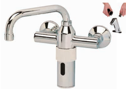
10lt/min Μπαταρίας 17027 E2015/2 νεροχύτη 2 παροχών • με προ-ρύθμιση θερμοκρασίας και βαλβίδες αντεπιστροφής (η μπαταρία 9V περιλαμβάνεται) • Προβολή 25cm
