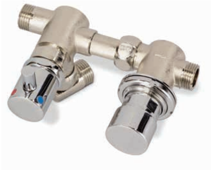
14lt/min 2 παροχών 1/2 17420 800/729 βαλβίδα γονάτου μίξεως • Με βαλβίδες αντεπιστροφής • Χρόνος λειτουργίας περίπου 10sec • 2 οπές εγκατάστασης Φ35/μπουτόν Φ26/ανάμειξη
