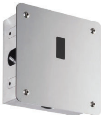
Ρεύματος 17587 7014VC Βαλβίδα έκπλυσης ουρητηρίου με φωτοκύτταρο • Ανοξείδωτο κουτί • Χρόνος λειτουργίας 3-5sec • 220V • Διακόπτης • Κουτί Υ.15,5xΠ.15,5xΒ.6cm
