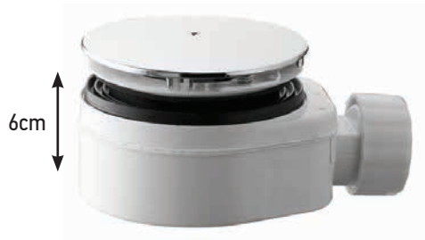
25lt/min Mini Φ118xΦ40 3526 Ava Mini σιφόνι ντουζιέρας με ύψος εντοιχισμού 6cm, οπή ντουζιέρας Φ90, έξοδος Φ40-1.1/2, κάλυμμα ABS
