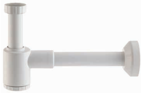
58lt/min Φ32x1.1/4 2881 Crono-TEA σιφόνι νιπτήρα από PP, κουμπωτή είσοδος και έξοδος, η έξοδος στο σώμα του σιφονιού είναι 40x32
