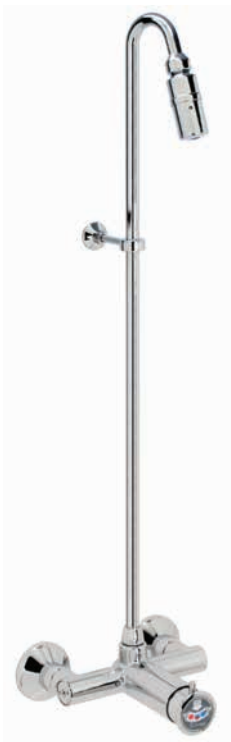
9lt/min 2 παροχές 3/4x1/2 16994 R749/7 βαλβίδα ντουζιέρας μίξεως • Χρόνος λειτουργίας ρυθμιζόμενος 0-50sec • Κολόνα Φ14-90cm
