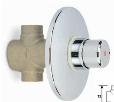
9lt/min 2 παροχές 1/2 16974 R7510/42 βαλβίδα ντουζιέρας μίξεως εντοιχισμένη • Χρόνος λειτουργίας ρυθμιζόμενος 0-50sec • Ροζέτα 12x19cm
