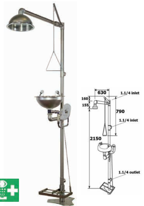
12 - 110lt/min 1.1/4 17453 R29051/4 ντουζιέρα και νιπτήρας έκπλυσης Inox • Νιπτήρας Inox • Λαβή από αλουμίνιο • Κώδωνας Φ230-1" 100lt/min
