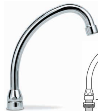
1/2 17073 80000/33 ρουξούνι περιστρεφόμενο Φ18, οπή πάγκου Φ21, ροζέτα Φ33
