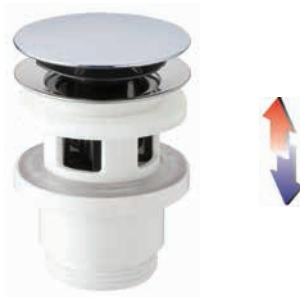
Χρωμέ Ενεργό 32-52mm 3412 TEA βαλβίδα νιπτήρα Clicker με υπερχειλίση, από ABS, με ορειχάλκινη τάπα \Phi 63 \times 1.1/4
