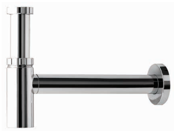
34lt/min \Phi 32 \times 1.1/4 15708 Jolly mini-TEA σιφόνι νιπτήρα Inox + Zinc alloy
