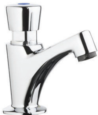
4,2lt/min 1 παροχή 1/2 16570 9002 κάνουλα πάγκου • Χρόνος λειτουργίας 8-12sec • Οπή πάγκου Φ22-35
