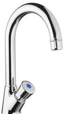
4,2lt/min 1 παροχή 1/2 16642 9091B κάνουλα πάγκου περιστρεφόμενη • Χρόνος λειτουργίας 8-12sec • Οπή πάγκου Φ22-37
