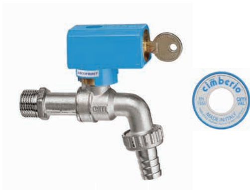
1/2 x 3/4 1854 Cim34/1 SI κάνουλα σφαιρική με κλειδαριά, αντιπαγωτική, με καρούλι Teflon
