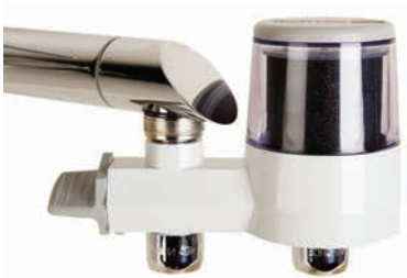
Mike 1340 Ανταλλακτικό 1341 WF Mike φίλτρο βρύσης ενεργού άνθρακα Ιταλίας • Παροχή 1,9 lt/min • Αλλαγή φίλτρου κάθε 2-3 μήνες
