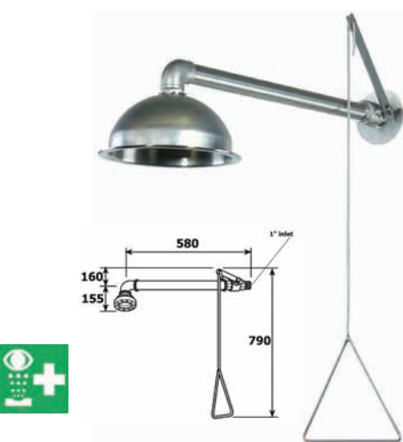
100lt/min 1" 17457 R29028/4 σύστημα ντους ανοξείδωτο • Με λαβή και κώδωνα Φ230 inox
