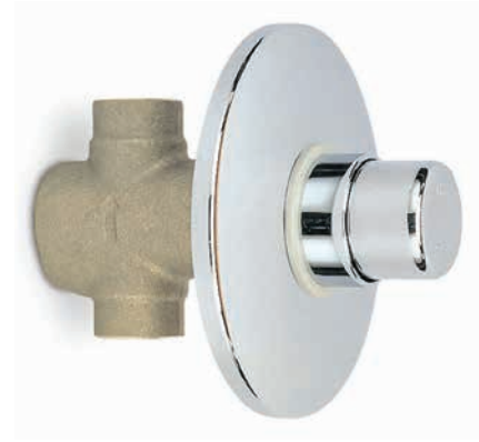
7lt/min 1/2 16968 R737 βαλβίδα εντοιχισμένη έκπλυσης ουρητηρίου • Χρόνος λειτουργίας 6sec • Ροζέτα Φ117
