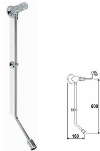
7lt/min 1/2 16909 R7800 έκπλυση ποδιών • Χρόνος λειτουργίας ρυθμιζόμενος 0-50sec • Σωλήνα Φ14-76cm
