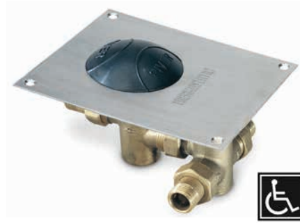
2 παροχών 1/2 16988 R771 βαλβίδα θερμοστατική ενδοδαπέδια • Ρυθμιστής ροής • Φίλτρα • Βαλβίδες αντεπιστροφής • Πλάκα ανοξείδωτη 16x13cm
