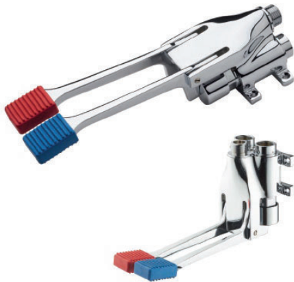
2 παροχών 1/2 16603 9010 ποδοβαλβίδα 2 παροχών με 2 πεντάλ, δαπέδου – τοίχου • Ανάμειξη νερού πατώντας ταυτόχρονα
