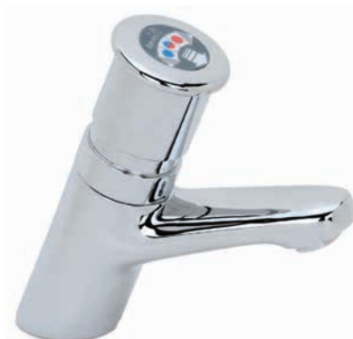
7lt/min 2 παροχές 3/8 17020 R715/61 κάνουλα πάγκου μίξεως • Ρυθμιζόμενος χρόνος λειτουργίας 0-30sec. • Μπουτόν ορειχάλκινο • Με βαλβίδες αντεπιστροφής και φίλτρα
