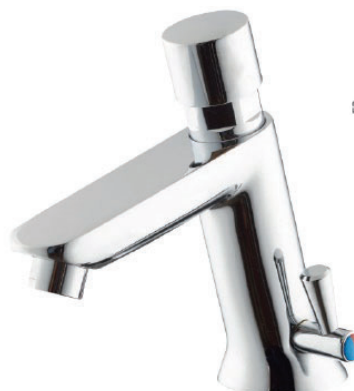
4,2lt/min 2 παροχές 1/2 17592 9777 κάνουλα πάγκου μίξεως • Χρόνος λειτουργίας 8-12sec • Οπή πάγκου Φ22-37
