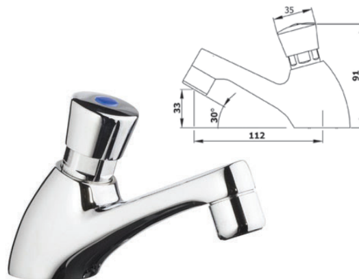
4,2lt/min 1 παροχή 1/2 17591 9001A κάνουλα πάγκου • Χρόνος λειτουργίας 8-12sec • Οπή πάγκου Φ22-35
