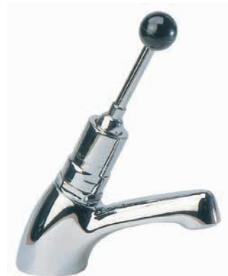
7lt/min 1 παροχή 1/2 17007 R711 κάνουλα πάγκου • Χρόνος λειτουργίας 20sec • Οπή πάγκου Φ22-30
