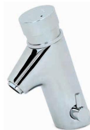
7lt/min 2 παροχές 3/8 17471 R7150/2 κάνουλα πάγκου μίξεως • Ρυθμιζόμενος χρόνος λειτουργίας 0-30sec. • Μπουτόν ορειχάλκινο • Με βαλβίδες αντεπιστροφής και φίλτρα
