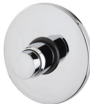
4lt/min 1 παροχή 1/2-Φ15 16639 9005 βαλβίδα ντουζιέρας εντοιχισμένη • Χρόνος λειτουργίας 15-25sec • Βάθος εντοιχισμού 5,3cm • Ροζέτα Φ117
