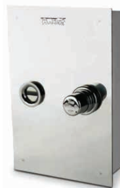
1,2lt/sec Ρεύματος 3/4 17465 E2079 βαλβίδα έκπλυσης WC με φωτοκτύπαρο και μπουτόν • Ανοξείδωτο κουτί • Βίδες ασφαλείας • Χρόνος λειτουργίας ~8sec φωτοκτύπαρο / 0-12sec μπουτόν • 230V-50Hz • Κουτί Υ.32xΠ.20,5xB.8cm
