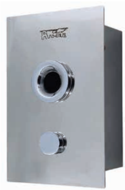
Full Flow Ρεύματος 17466 E2038/3/230 βαλβίδα εντοιχισμού έκπλυσης ουρητηρίου με φωτοκύτταρο • Ανοξείδωτο κουτί • Βίδες ασφαλείας • Διακόπτης • Χρόνος λειτουργίας ~8sec • Κουτί Υ.17xΠ.11xB.7,5cm
