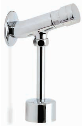
4lt/min 1/2 16979 R00730 βαλβίδα έκπλυσης ουρητηρίου • Χρόνος λειτουργίας 6sec • Σωλήνα Φ14 - 25cm
