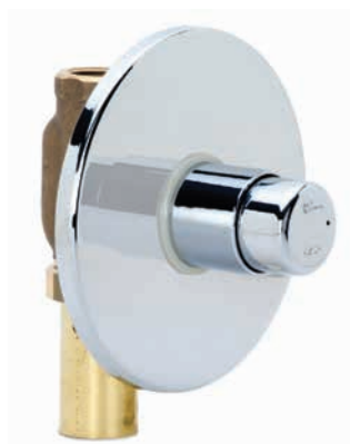
1,2lt/sec 3/4 16949 R732/09 βαλβίδα εντοιχισμένη έκπλυσης WC • Ρυθμιζόμενος χρόνος λειτουργίας 0-12sec • Σωλήνα εξόδου Φ30 • Ροζέτα Φ137
