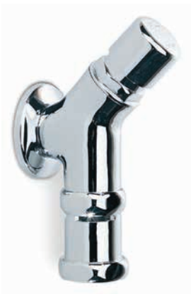
1,2lt/sec 3/4 16948 R731 βαλβίδα έκπλυσης WC • Ρυθμιζόμενος χρόνος λειτουργίας 0-12sec • Δέχεται σωλήνα Φ28-30
