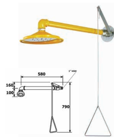
100lt/min 1" 17458 R29028/2 σύστημα ντους • Με λαβή και κώδωνα Φ240 ABS με ανοξείδωτα σίτα
