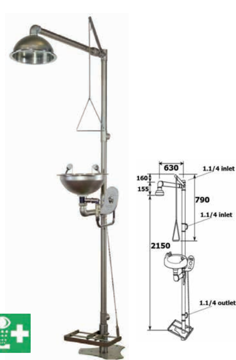
12 - 110lt/min 1.1/4 17453 R29051/4 ντουζιέρα και νιπτήρας έκπλυσης Inox • Νιπτήρας Inox • Λαβή από αλουμίνιο • Κώδωνας Φ230-1" 100lt/min
