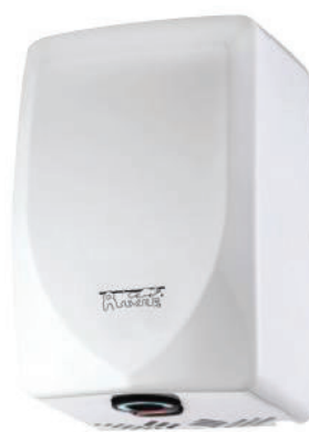
ABS Λευκό 17594 Ε612 Στεγνωτήρας χειρών ηλεκτρονικός, χρόνος λειτουργίας 10-12sec, 230V 50/60Hz 1000W, ταχύτητα αέρα 100MS, θερμοκρασία αέρα 40°C, Υ.25,6xΠ.17,4xΒ.10,2cm
