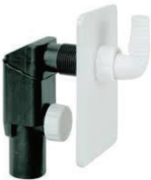
34lt/min Φ40/50 x 1" 10383 Σιφόνι πλυντηρίου, από PEHD, πλάκα Inox
