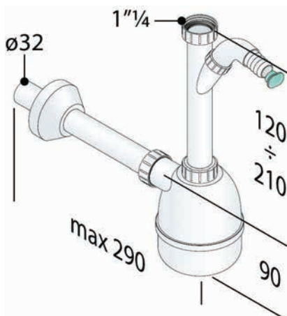
59lt/min Φ40x1.1/2 1632 Σιφόνι νεροχύτη για 1 γούρνα, από PP
