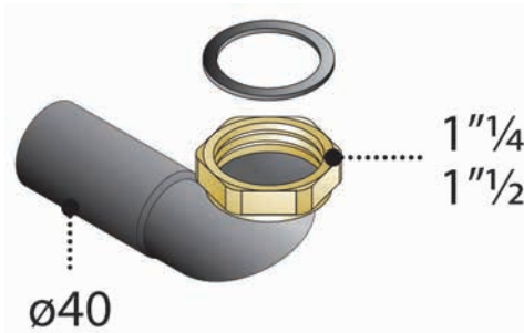
Φ40x1.1/4 10399 Φ40x1.1/2 10398 Ρακόρ γωνιακό με ορειχάλκινο παξιμάδι
