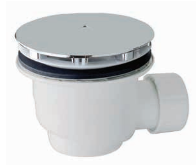
27lt/min Φ118xΦ40 3421 Vega σιφόνι ντουζιέρας με ύψος εντοιχισμού 8,7cm, οπή ντουζιέρας Φ90, έξοδος Φ40-1.1/2, κάλυμμα ABS
