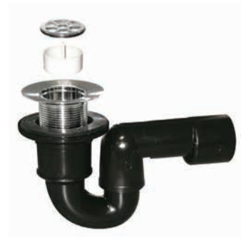
38lt/min Φ80xΦ40/50 10499 Σιφόνι ντουζιέρας με ύψος εντοιχισμού 12cm, οπή ντουζιέρας Φ63, έξοδος Φ40/50, κάλυμμα ορειχάλκινο
