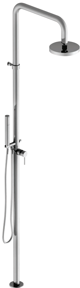
Χρωμέ (CR) 14685 *Χρωμέ (CR) *14688 Σύστημα ντους δαπέδου - Κολώνα Φ42 - Κώδωνας Φ200 Προβολή 350mm - Ύψος 2180mm *με θερμοστατικό μηχανισμό
